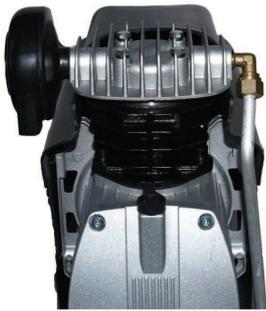
Öl-Einfüllverschraubung mit Entlüftung
